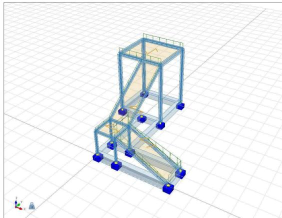
Schema strutturale della nuova scala
